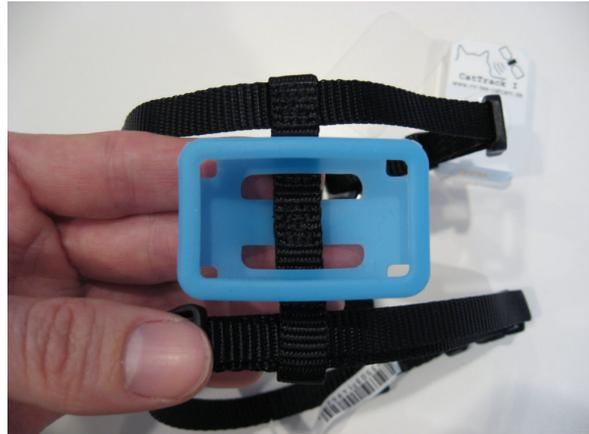
Den GPS Logger in die Halterung einsetzen. Stellen Sie sicher dass die Oberseite in Richtung Himmel zeigt.
