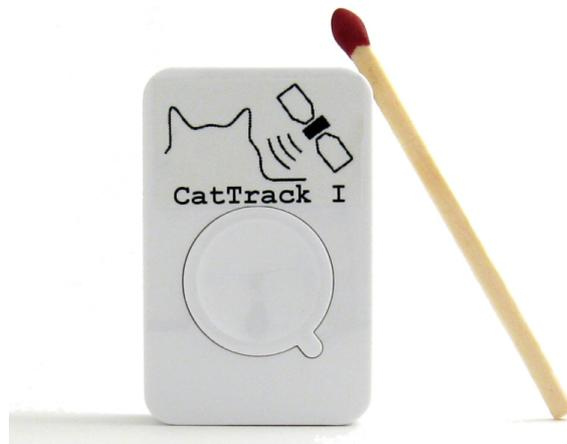
Das Gerät ist wasserfest und hat eine eingebaute wiederaufladbare Batterie die eine Nutzungsdauer von 30 Stunden und mehr ermöglicht. Die USB Schnittstelle dient zum laden und Datentransfer. Aufgezeichnete Positionen werden direkt auf einer Google Maps Karte dargestellt (aktive Internetverbindung notwendig).
