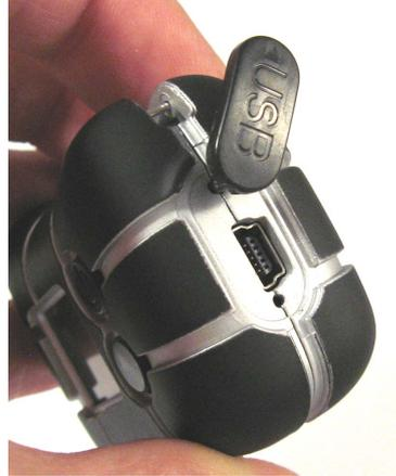
Die Kamera wird durch einen eingebauten Lithium-Polymer Akku versorgt. Das Aufladen der Kamera dauert etwa 3 Stunden.
