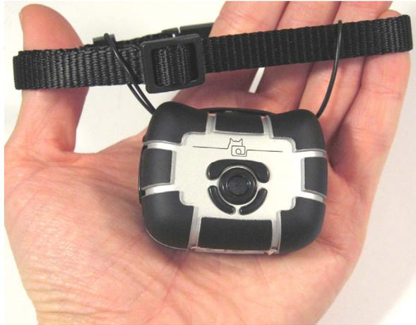
Die CatCam® ist eine kleine Digitalkamera welche am Halsband eines Tieres getragen wird, um tiefgehende Einblicke in sein Leben zu erhalten. Die Kamera nimmt automatisch Bilder oder Videoclips in einem einstellbaren Zeitintervall auf. Dies erlaubt auch den Einsatz für andere Anwendungen wie z.B. generelle Überwachungsaufgaben oder Zeitrafferaufnahmen. Wenn die Automatik abgeschaltet wird funktioniert die Kamera wie eine normale Digitalkamera.
